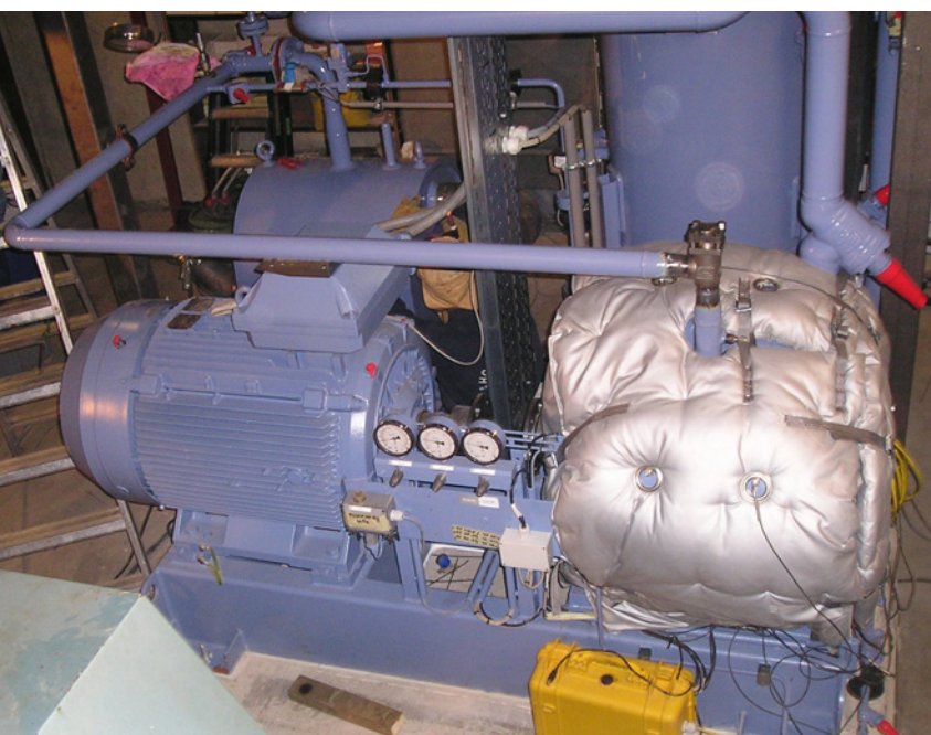
Veldtest met een add-on warmtepomp in een (te) koude machinekamer.
