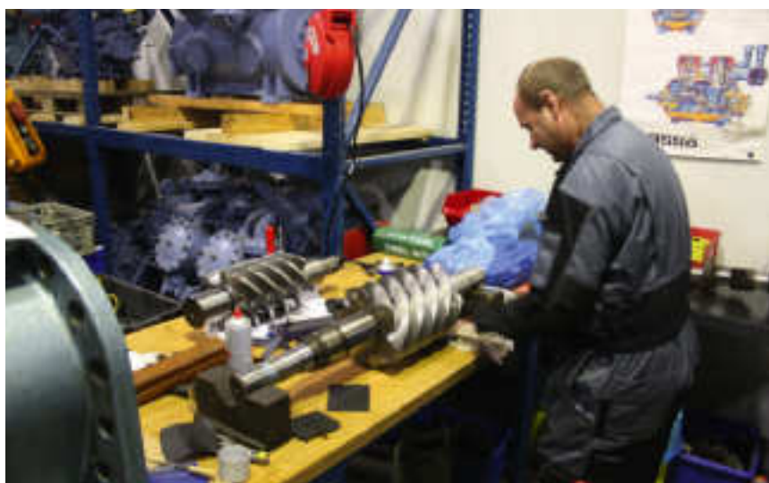
Onderhoud aan schroefcompressor.
